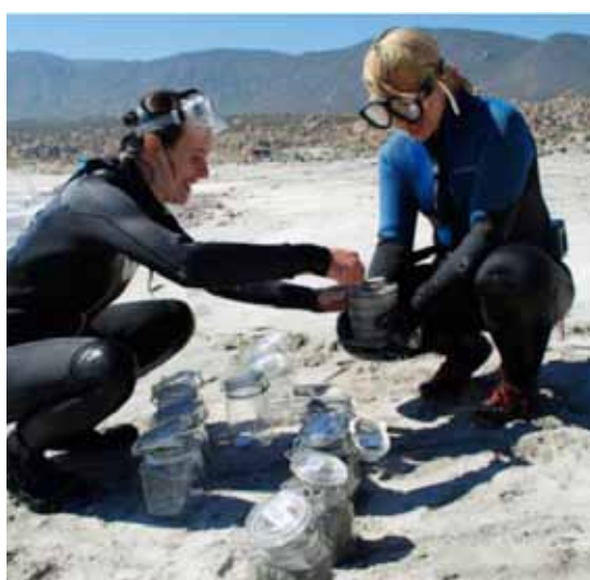
Abbildung 2: Sammeln von Sedimentproben am Standort Coquimbo in Chile. Die Proben wurden vor Ort in Transportbehälter umgefüllt und im Labor weiterbearbeitet.
