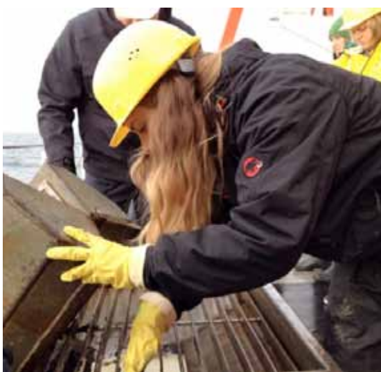
Die Benthosproben wurden mit dem Greifer vom Meeresboden geholt und gleich gespült und vorsortiert.
