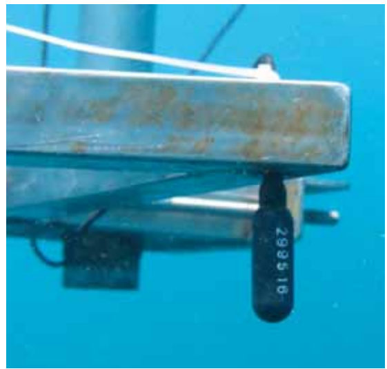
Die Hydrophone müssen in gleicher Wassertiefe liegen und einen Winkel von 90° zur Meeresoberfläche bilden.
